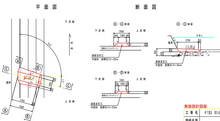
※袋詰玉石工を構造図の形状（各勾配、寸法等）に合わせて、現場にて調整のこと。
